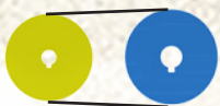
Courroie sur la première poulie entraînée Position 1 : vitesse réduite, mais puissance accrue
