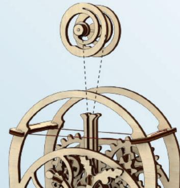
**ITA** Ingrassate l'asse centrale del rullo con un po' di cera, quindi montate il rullo sul pendolo. Impostate il timer con un orologio normale. Regolate la tensione dell'elastico. Aumentate la tensione, se il timer si ferma all'improvviso, riducete la tensione, se il timer funziona in modo caotico. (dis 6)
